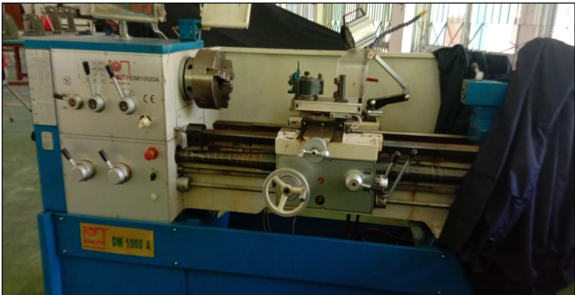
Gambar 3. Mesin Bubut Tipe 1000A
