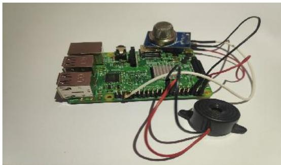
Gambar 2 Pemasangan Buzzer ke Raspberry
