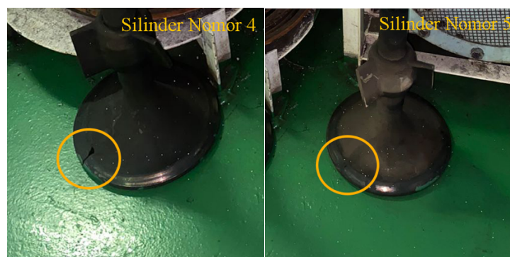
Gambar 3. Keretakan Spindle Exhaust Valve Silinder Nomor 4 dan 5 (Sumber: Dokumen Peneliti)
