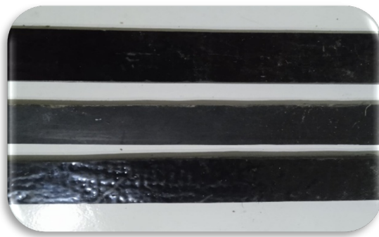
Gambar 1. Sampel komposit Poliester – serat nunang dengan variasi serbuk karbon (sampel 5% vol.)
