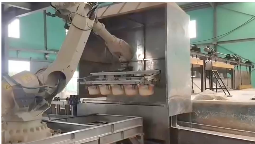
Gambar 3. Sistem otomasi pada proses dumping material panas
