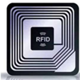
Gambar 2.3 Tag RFID bentuk Stiker
