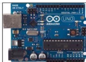
Gambar 2. Board Arduino Uno Spesifikasi Board Arduino Uno :
